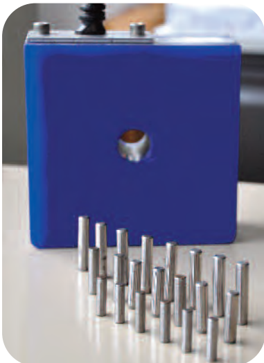
图示为一个典型的检测线圈和0.75”、1.00”和1.25”长的钢销，对应的信号见本页右上角图示
