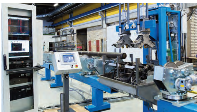
图示为Echowac® 管材旋转式超声波检测系统。左侧为Echowac 超声波仪器，右侧为动力滚轮装置，中间部分管材接近的装置为 APC探头架
