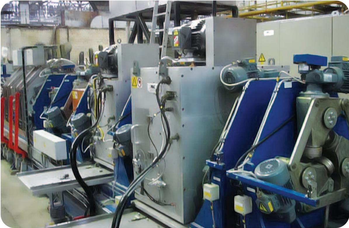
图示为一套安装在欧洲某大型管材厂内的带有横向和纵向旋转体的Rotoflux®检测系统，该系统可检测直径在50-180mm(1.97" - 7")范围内的普通油井管壁厚5%或10%深度的人工槽伤。检测符合API 5CT - Rev 8标准的要求。纵向漏磁单元包含旋转磁极和传感器；横向漏磁单元将磁极固定在垂直于管材的轴线位置。
