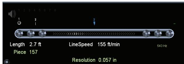
Track界面-实时显示产品、长度、线速度、端部抑制、缺陷跟踪、件数以及输出（警报）设置。可以有效地提高质量控制、减少停机时间
