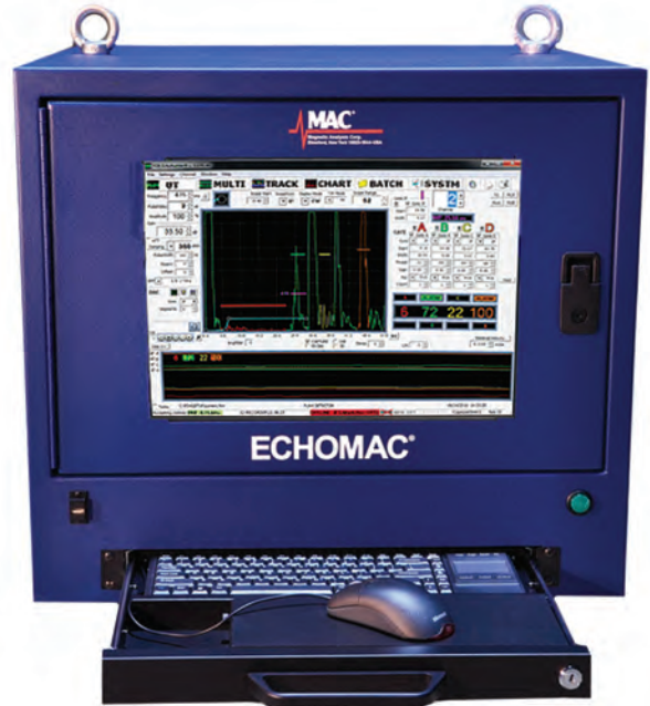
安装于CAB 002温控柜中的Echomac 超声波仪器
