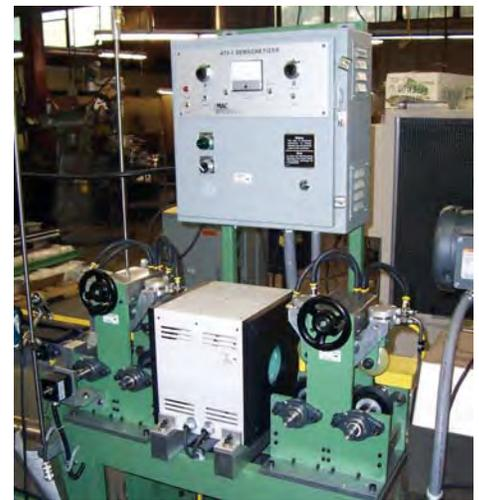
安装于“V”型辊平台上的475型退磁器
