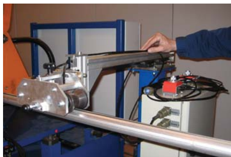
图10 - 65mm扇形线圈平台，带有浮动头功能选项和一个涡流探头，滑入检测位置来检测TIG焊管。同样使用双探头来检测激光焊管。
